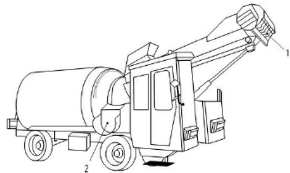
b) Carro desilatore semovente con miscelatore cilindrico
