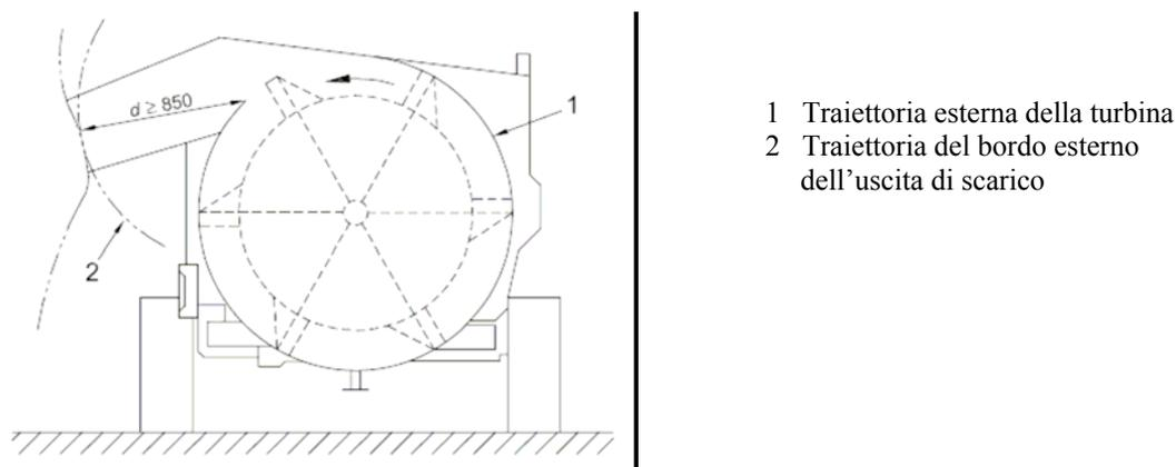
**Figura 10. Protezione contro il pericolo di pizzicamento con le turbine. Dimensioni in mm.**
