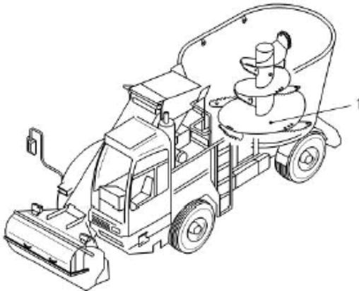
a) Carro desilatore miscelatore semovente verticale
