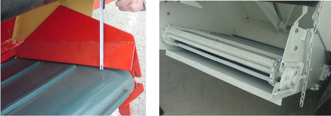
Figura 21. Esempi di protezione applicata al nastro trasportatore.
