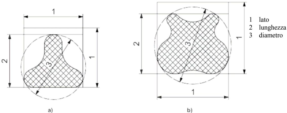
Figura 12. Esempi di aperture di forma irregolare.
