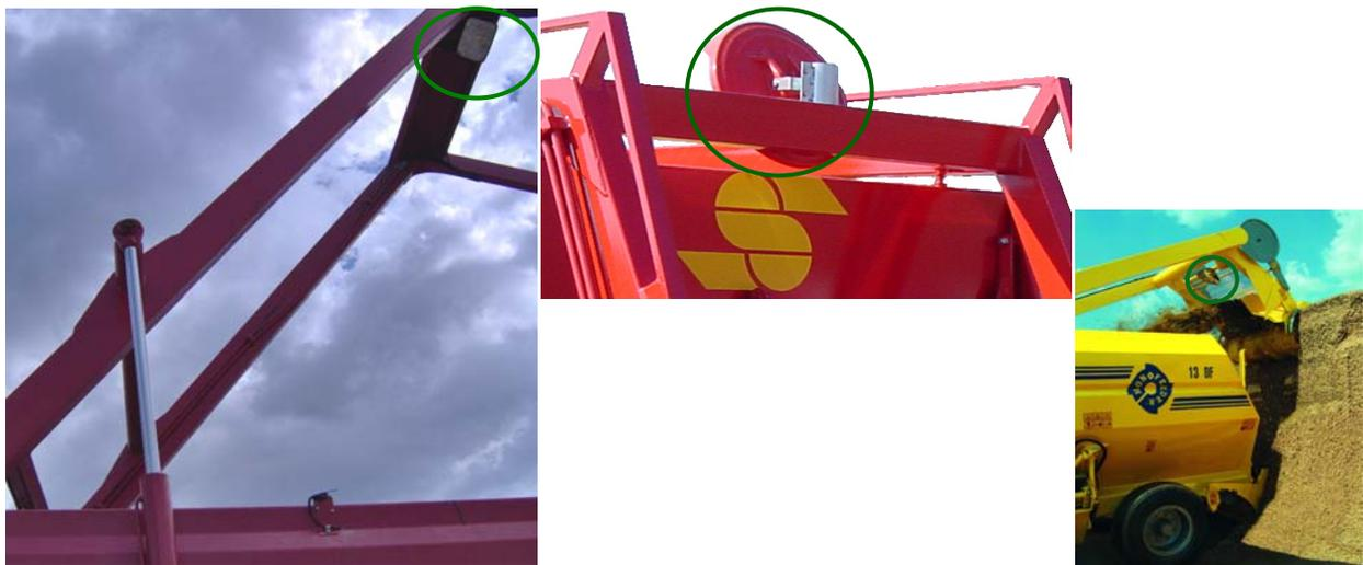
Figura 15. Esempi applicativi di specchi (evidenziati in figura) installati sulla struttura portante dei bracci dell'organo di taglio (fresa).
