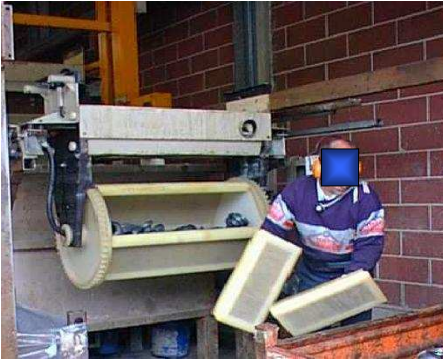
Foto 12: impianto in linea con utilizzo di rotobarili (operazione di scarico)
