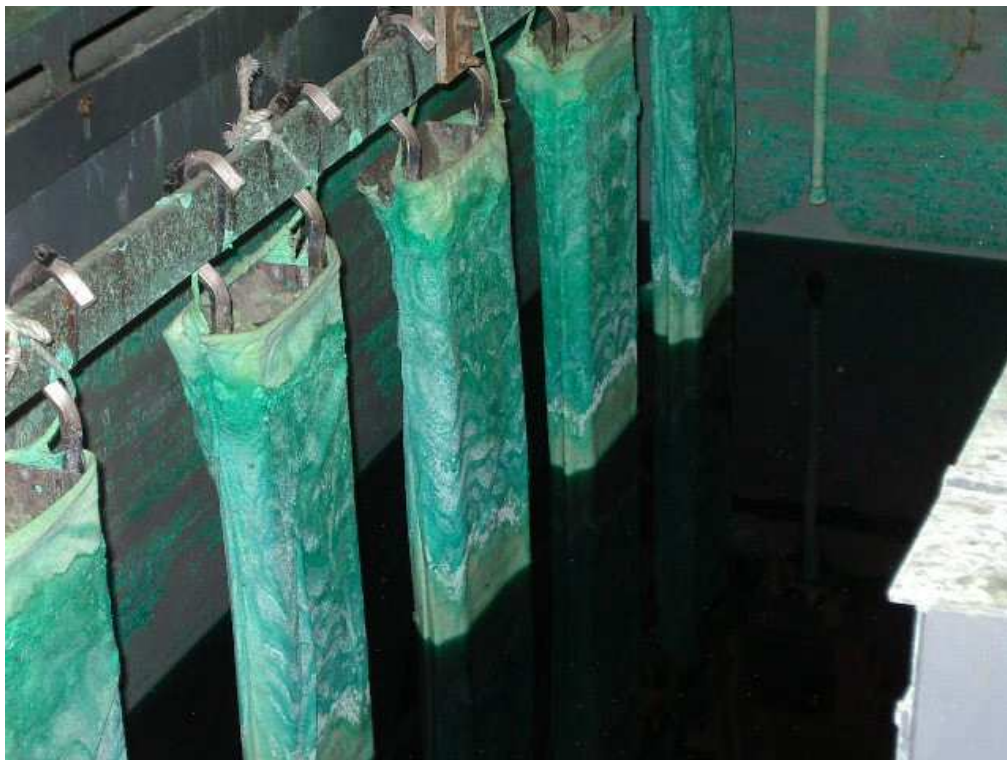
Foto 2: cestelli anodici in una vasca di nichelatura.
