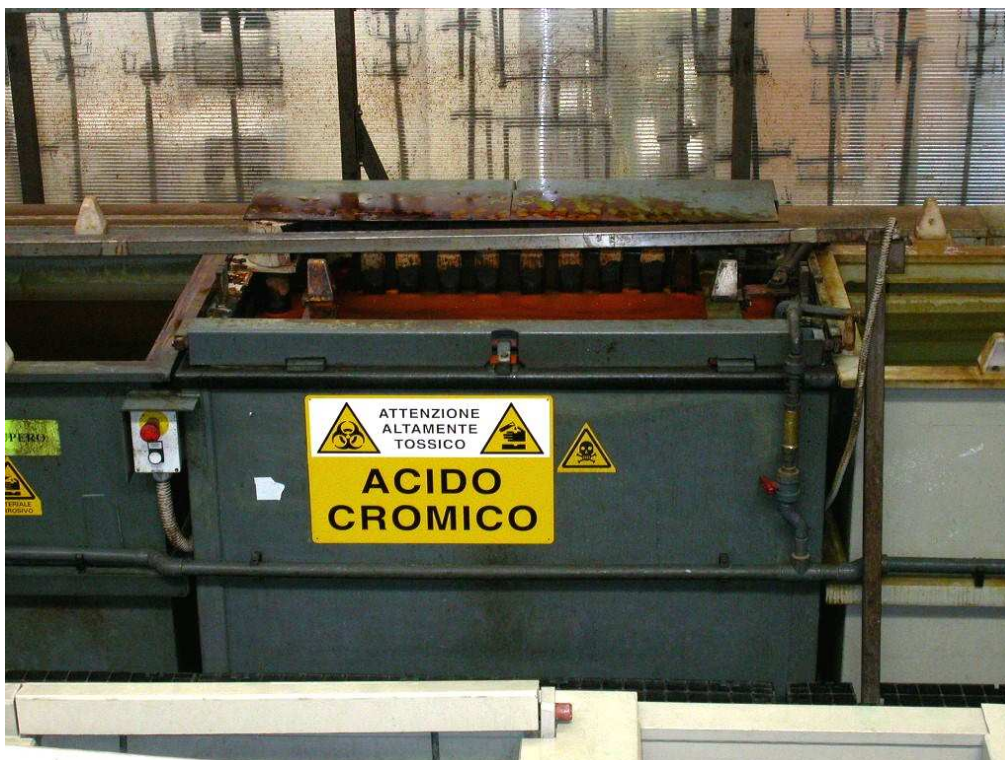
Foto n. 24: esempio di etichettatura
