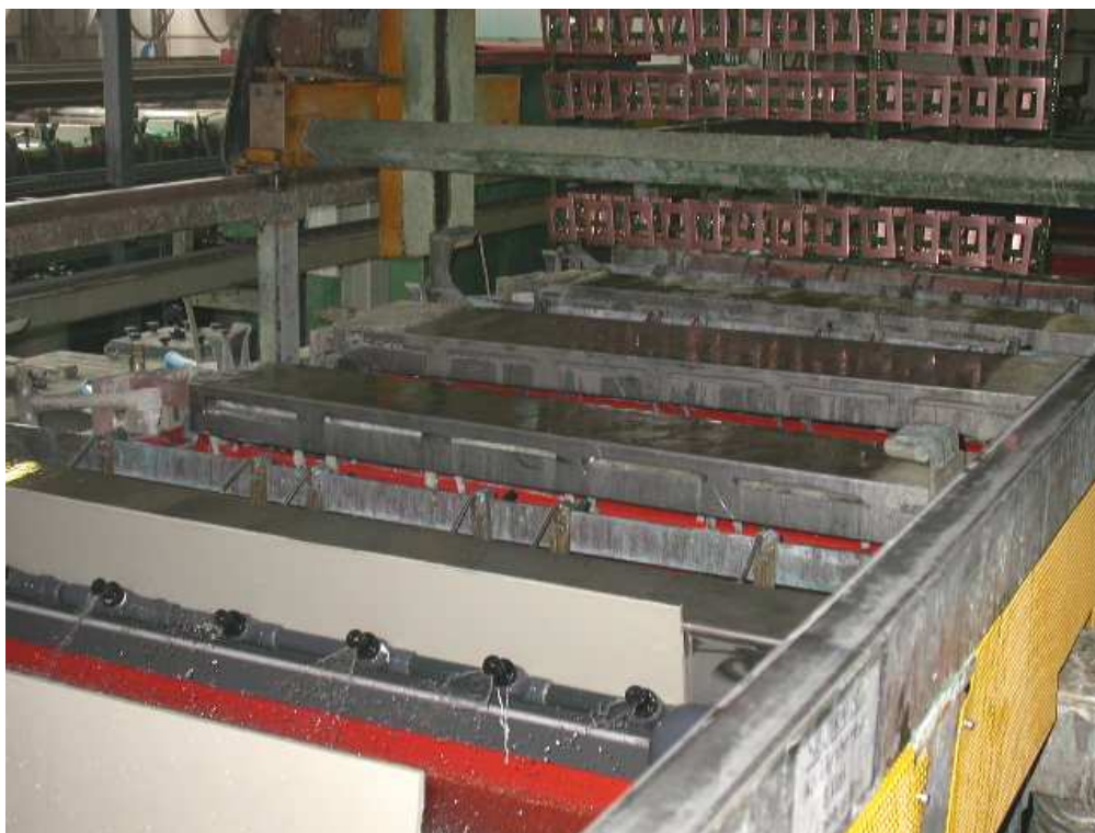
Foto n. 5: metallizzazione chimica di placche per interruttori
