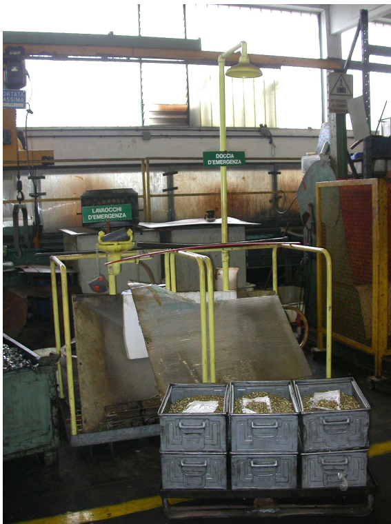
Foto n. 25: doccia e lavaocchi non accessibili
