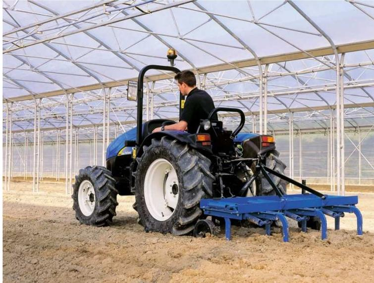
*Struttura di protezione in caso di capovolgimento di tipo abbattibile*
