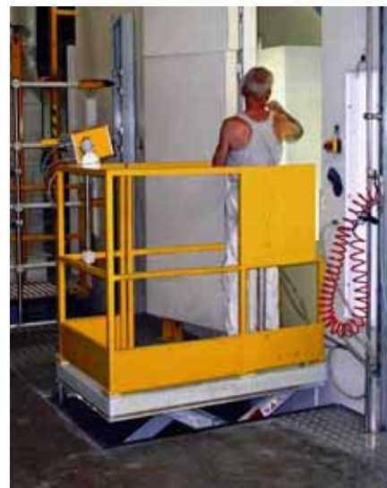
Figura 5 Questa piattaforma elevabile a forbice può raggiungere un'altezza massima di 1 m. Grazie al parapetto lungo il dislivello con il pavimento, l'utente è protetto dal pericolo di caduta, ad esempio se dovesse inavvertitamente fare un passo all'indietro. In base alle caratteristiche del posto di lavoro può essere necessario installare un parapetto anche ad un'altezza inferiore a 500 mm.
