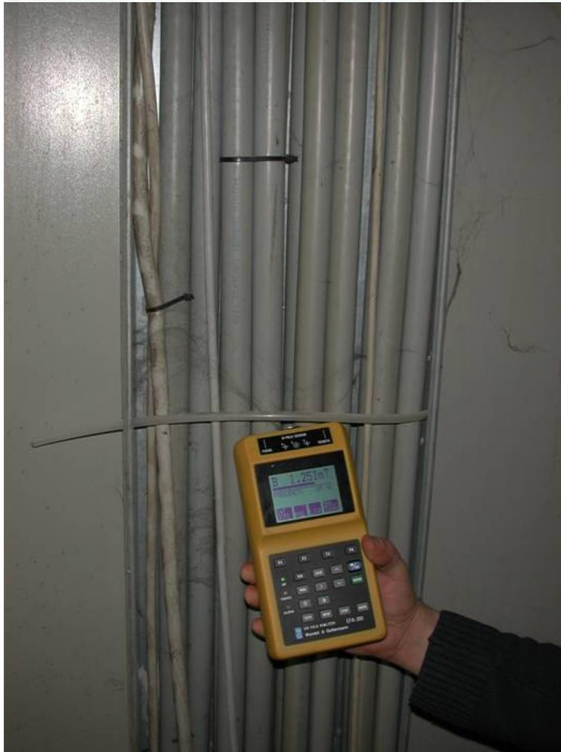
nell'industria per la produzione di grandi elettrodi per archi voltaici nel processo di "grafitazione" degli elettrodi sono stati riscontrati dei livelli di induzione magnetica a 50 Hz tra 1 e 10 mTesla, in postazioni di lavoro lontane dal processo ma interessate dai cablaggi di alimentazione
