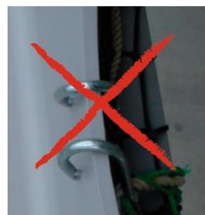
3 I moschettoni aperti perdono molto in termini di resistenza. In generale, non vanno utilizzati per montare le reti.
