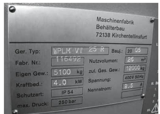
Fig 3: non si deve mai passare la vernice sulle targhette del tipo, le indicazioni del carico, i tubi idraulici ecc.
