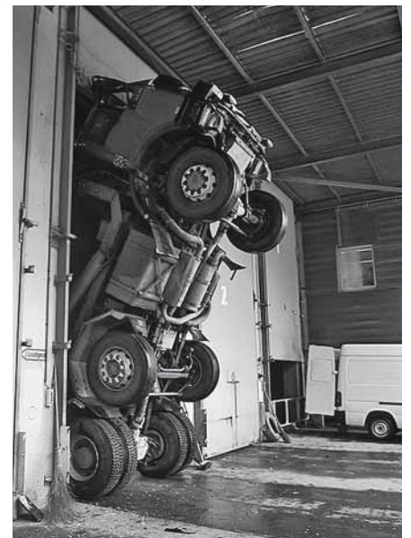
Fig. 7: qui lo scarico è avvenuto senza prima posizionare i piedi di supporto. Durante il ribaltamento e lo svuotamento, agiscono sul veicolo notevoli forze che non vanno sottovalutate.
