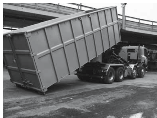
Fig. 3: area di deposito piana e portante, senza la presenza di persone, con veicolo a distanza di sicurezza rispetto alle linee elettriche.
