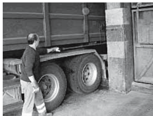
Fig. 6: aprire lo sportello stando di lato al di fuori della zona di pericolo.
