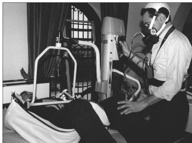
Figura 1. L'immagine rappresenta un operatore che indossa un sistema telemetrico di misura del consumo di O 2 durante un'azione di sollevamento eseguita mediante sollevatore elettromeccanico a corsetto dotato di sistema "a cambio postura"
