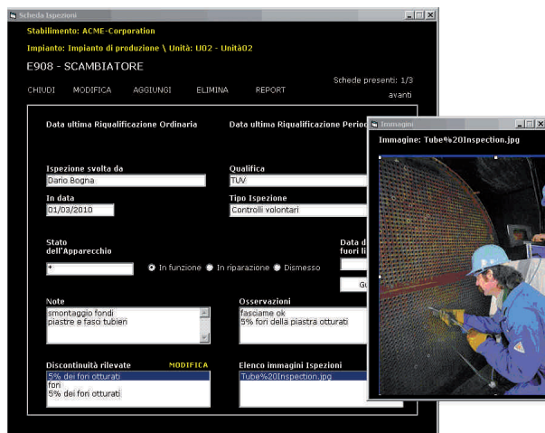
Figura 4.5.2.2.f Scheda ispezione pronta per l'archiviazione. Trattasi di uno scambiatore di calore, con piastra tubiera
