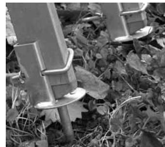
Fig. 3: se la base di appoggio è morbida (terreno cedevole), i puntali di metallo possono bloccare la scala e impedirne lo scivolamento.
