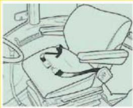
Le cinture di sicurezza addominali sono necessarie in caso di ribaltamento per evitare il rischio di schiacciamento tra il suolo e la struttura di protezione.
