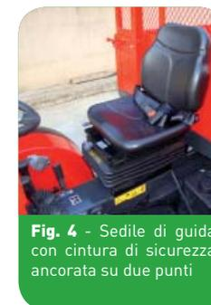
Fig. 4 - Sedile di guida con cintura di sicurezza ancorata su due punti
