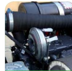
**Foto 21** – Clacson posizionato nel vano motore.
