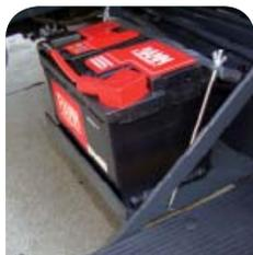
**Fig. 7** - Batteria elettrica opportunamente isolata su motoagricola
