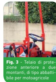
Fig. 3 - Telaio di protezione anteriore a due montanti, di tipo abbattibile per motoagricole
