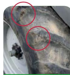
**Foto 22** – Pneumatici particolarmente usurati e battistrada rovinati.
