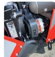
**Fig. 10** - Protezione con fessure per cinghia alternatore motore
