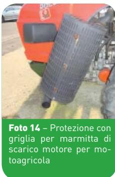
Foto 14 – Protezione con griglia per marmitta di scarico motore per motoagricola.
