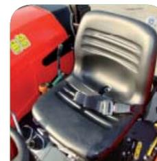
**Fig. 2** - Sedile di guida con cintura di sicurezza ancorata su due punti
