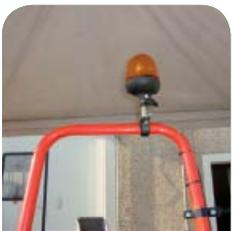
**Foto 20** – Girofarò applicato su telaio di protezione per motoagricola.
