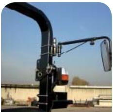
**Foto 18** – Specchietto retrovisore regolabile applicato su telaio di protezione per trattore agricolo.
