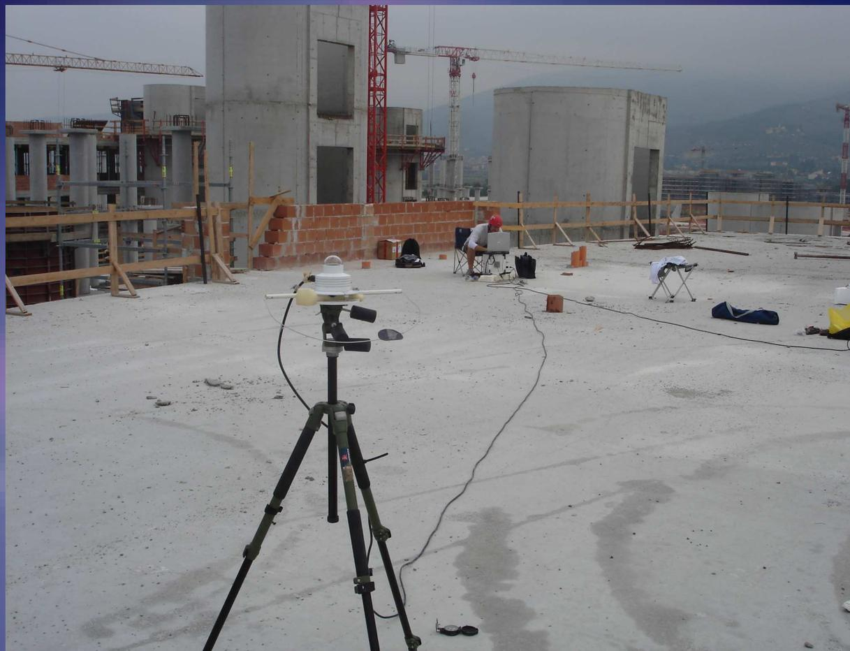
**Solarimetro Solar Light per la misura
