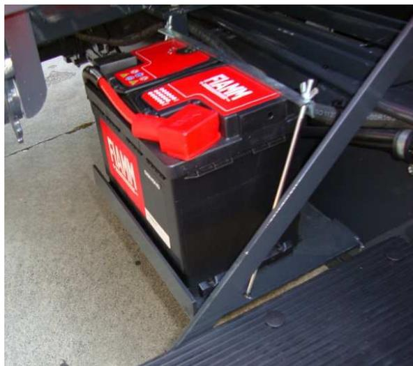
**Fig. 7** – Batteria elettrica opportunamente isolata su Motoagricola
