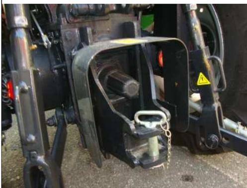
**Fig. 11** – Presa di potenza posteriore con protezione e gancio di traino con spina di fermo e catenella per **trattore agricolo**
