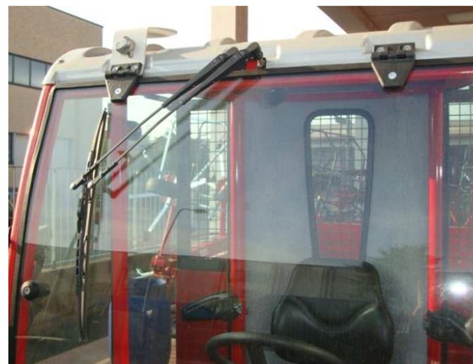
**Fig. 17** – Tergicristallo azionato da motorino elettrico su cabina per Motoagricola
