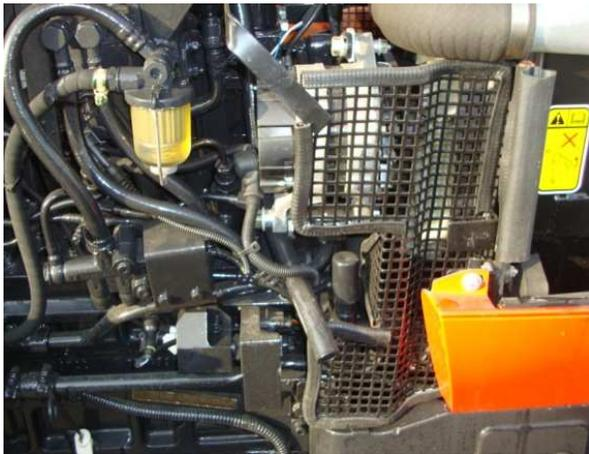
**Fig. 9** – Protezione con griglia per cinghie motore e ventola di raffreddamento
