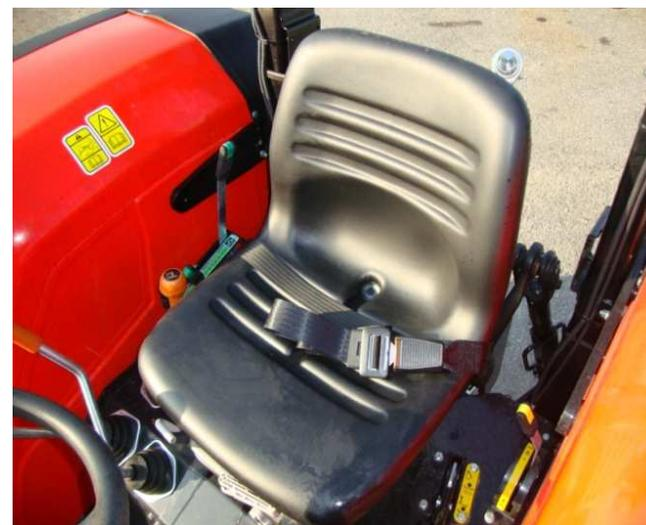
*Fig. 2 – Sedile di guida con cintura di sicurezza ancorata su due punti*
