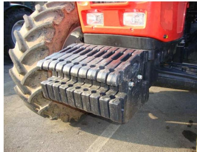
**Fig. 15** – Zavorre anteriori opportunamente posizionate e fissate su trattore agricolo
