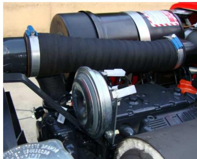
**Fig. 21** – Clacson posizionato nel vano motore
