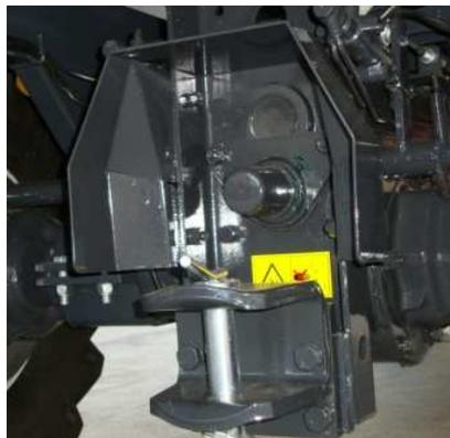
**Fig. 12** – Presa di potenza posteriore con protezione e gancio di traino con spina di fermo per **Motoagricola**
