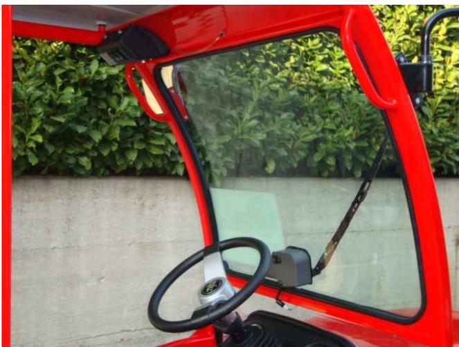
**Fig. 16** – Parabrezza multistrato su semicabina per Motoagricola
