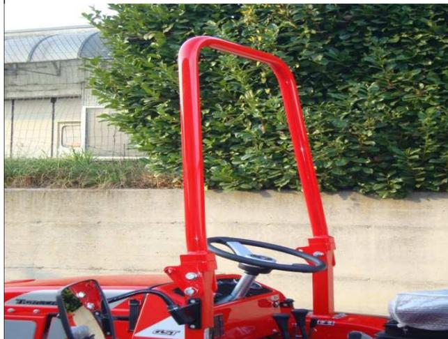
**Fig. 3** – Telaio di protezione anteriore a due montanti, di tipo abbattibile per Motoagricole
