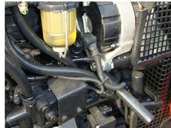
**Fig. 10** – Protezione con fessure per cinghia alternatore motore
