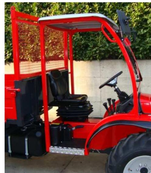
**Fig. 6** – Pedana salita al posto di guida per Motoagricola
