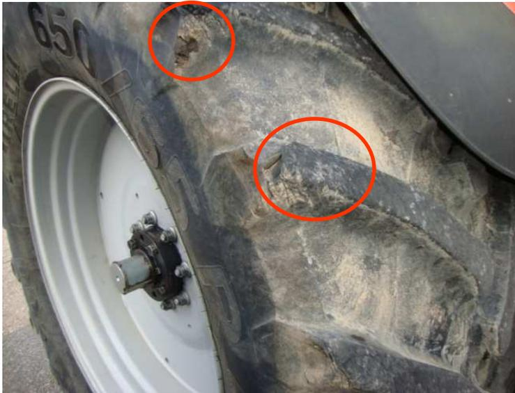
**Fig. 22** – *Pneumatici particolarmente usurati e battistrada rovinati*
