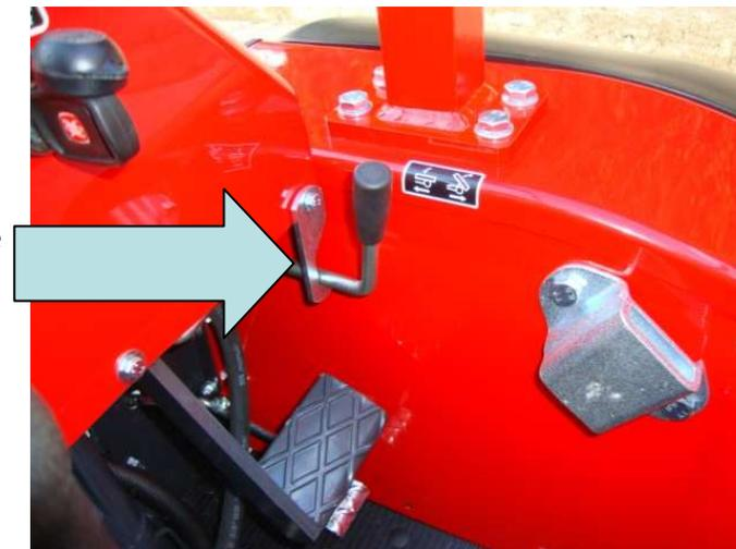
**Fig. 23** – *Gancio di sicurezza per comando di movimentazione pianale su Motoagricole*
