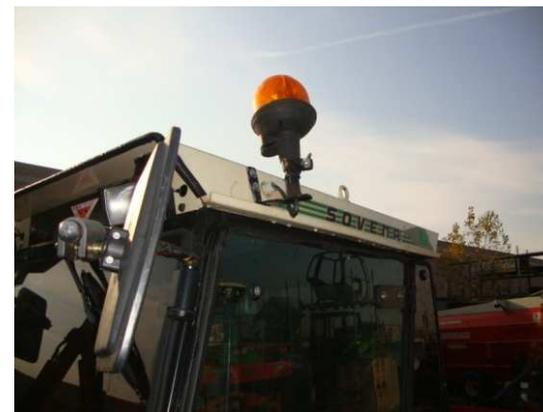
**Fig. 19** – Girofarò applicato su cabina di Trattore Agricolo
