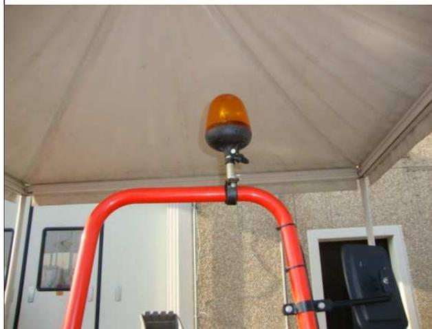
**Fig. 20** – Girofaro applicato su telaio di protezione per Motoagricola
