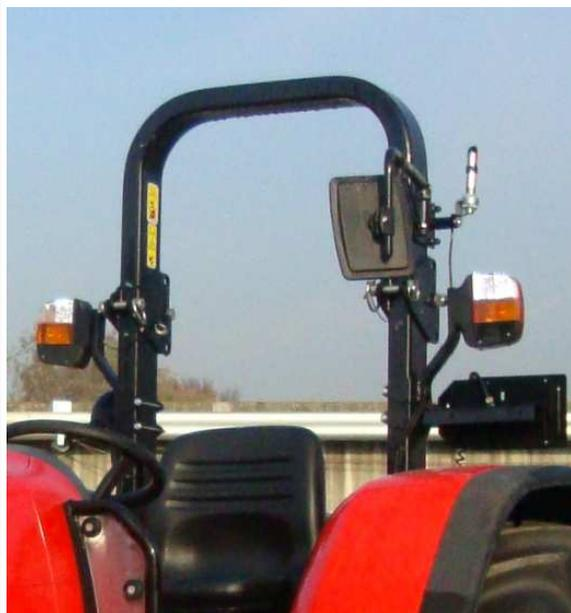
*Fig. 1 – Telaio di protezione posteriore a due montanti di tipo abbattibile per Trattore Agricolo*
