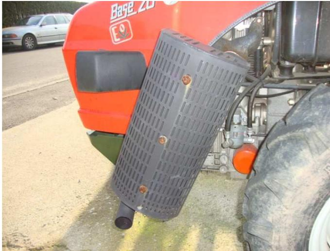
**Fig. 14** – Protezione con griglia per marmitta di scarico motore per **Motoagricola**
