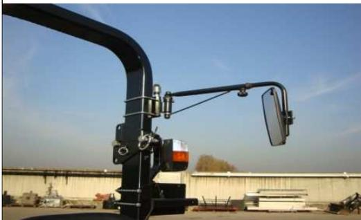
**Fig. 18** – Specchietto retrovisore regolabile applicato su telaio di protezione per Trattore Agricolo
