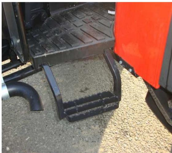
**Fig. 5** – Gradino di accesso al posto di guida per trattore agricolo
