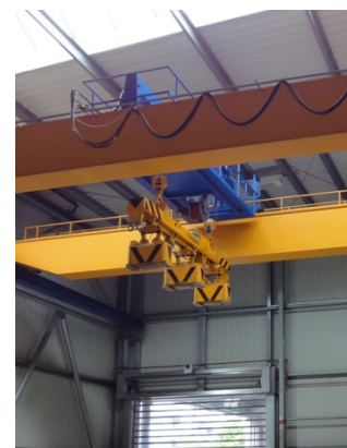
1 Accesso, piattaforma di sollevamento, piattaforma di servizio ancorata all'edificio e piattaforma di servizio ancorata alla gru (da sinistra a destra partendo dall'alto).
