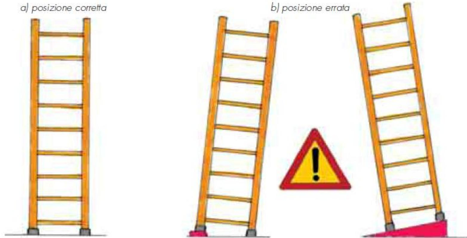
*Superficie inclinata lateralmente. Appoggiare la scala solo su superficie orizzontale*
