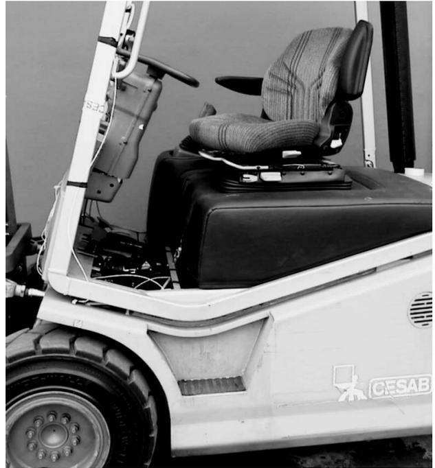
**Figura 11. Esempio di sedile girevole a 30°**
