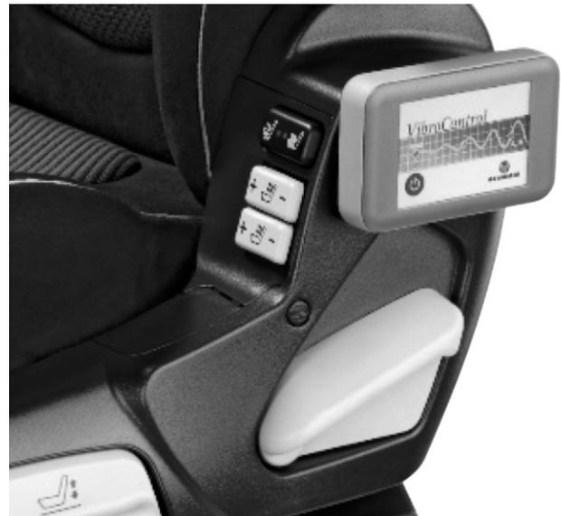
**Figura 14. Esempio di dosimetro per misurare le vibrazioni trasmesse**
