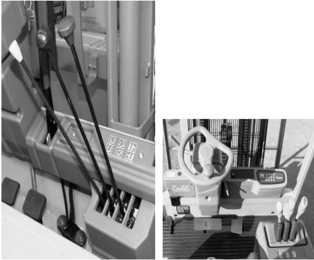
**Figura 8. Confronto fra comandi per la movimentazione del carico vecchi e nuovi**
