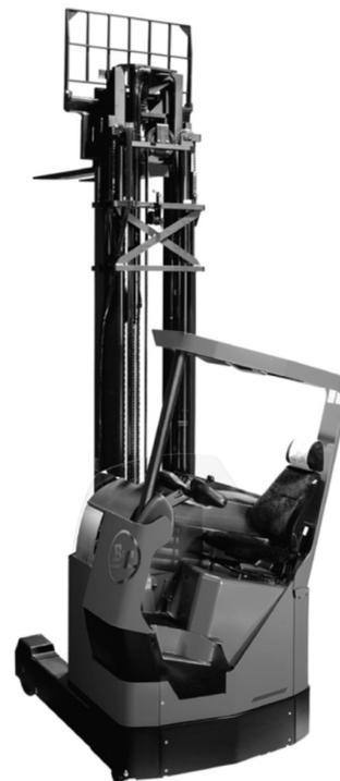
**Figura 12. Esempio di posto guida reclinabile**
