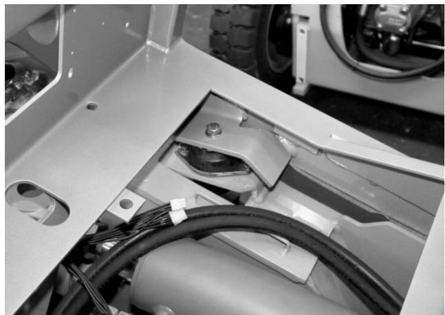
Figura 13. Esempio di sospensioni elastiche per il posto di guida del carrello
