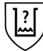
Fig. 8: pittogramma per guanti impermeabili con bassa resistenza ai prodotti chimici
