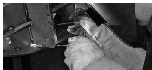
Fig. 5: guanti protettivi da saldatore resistenti alle alte temperature con buona sensibilità tattile
