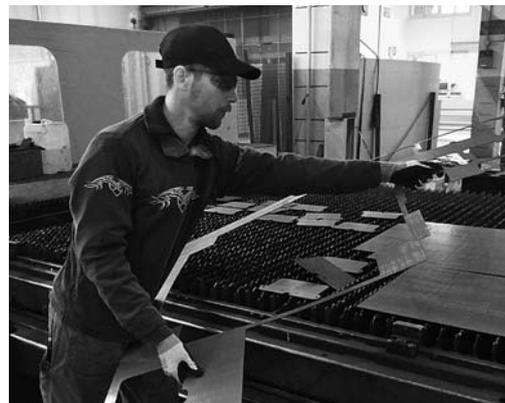
Fig. 1: guanti protettivi con resistenza al taglio  $\geq 3$  utilizzati per manipolare lamiere con spigoli vivi
