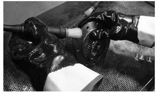
Fig. 6: solo i guanti protettivi resistenti al prodotto chimico specifico offrono una protezione ottimale
