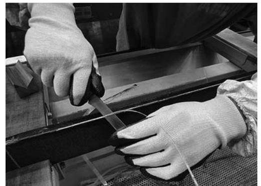
Fig. 9: guanti antitaglio con rivestimento parziale offrono una buona protezione e sono efficaci contro i tagli durante la manipolazione di pezzi leggermente oleosi e con spigoli vivi
