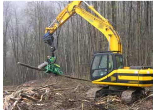
Testa harvester su macchina movimento terra
