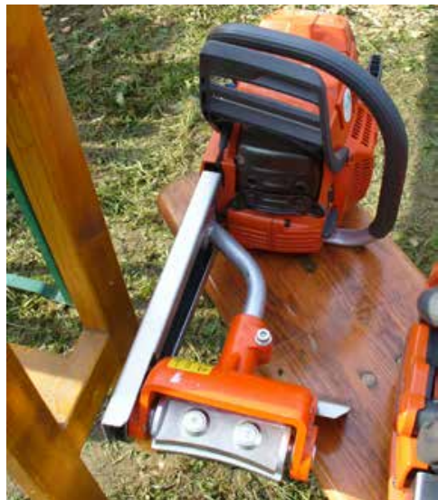
Testa scortecciatrice azionata da motore di motosega
