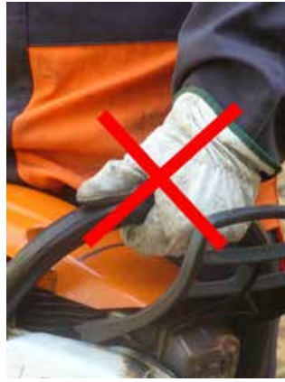
Img. 16a Errata impugnatura della motosega con il pollice aperto
