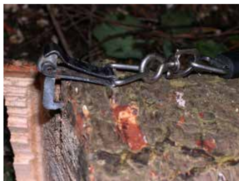
Uncino del nastro metrico autoavvolgente
