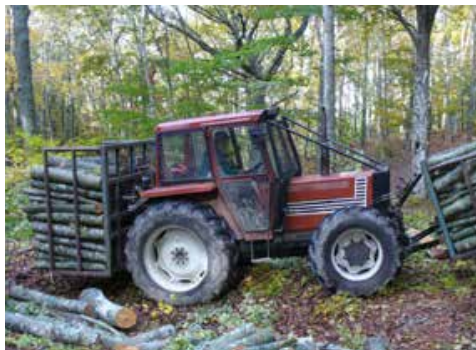
Esbosco con trattore allestito con gabbie
