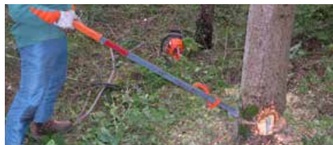
Corretto impiego della leva di atterramento
