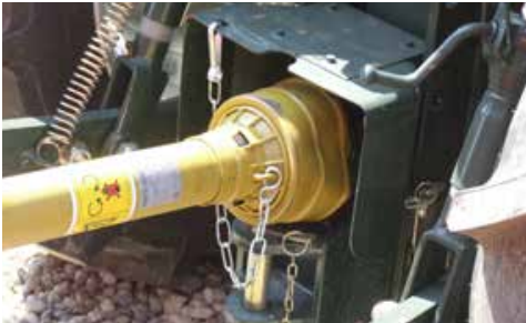
Img-83 Albero di trasmissione a doppio giunto cardanico con le adeguate protezioni
