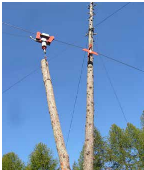
Img. 95 Teleferica tipo gru a cavo
