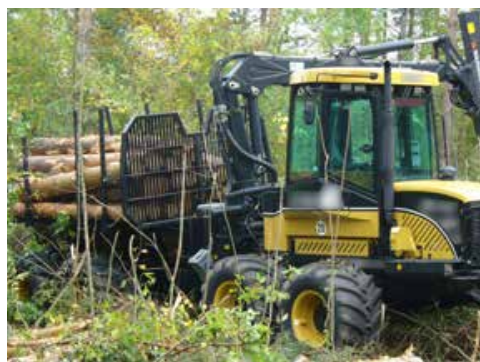
Img. 87 Trattore articolato portante, forwarder
