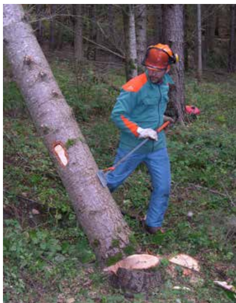
Corretto impiego della leva giratronchi
