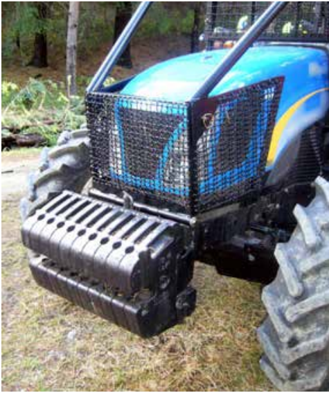
Img. 80 Trattore con zavorre anteriori
