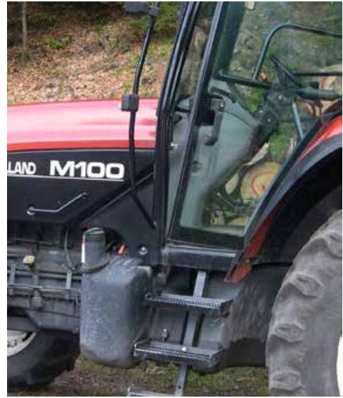
Img. 81 Scalino antiscivolo e maniglia di appiglio
