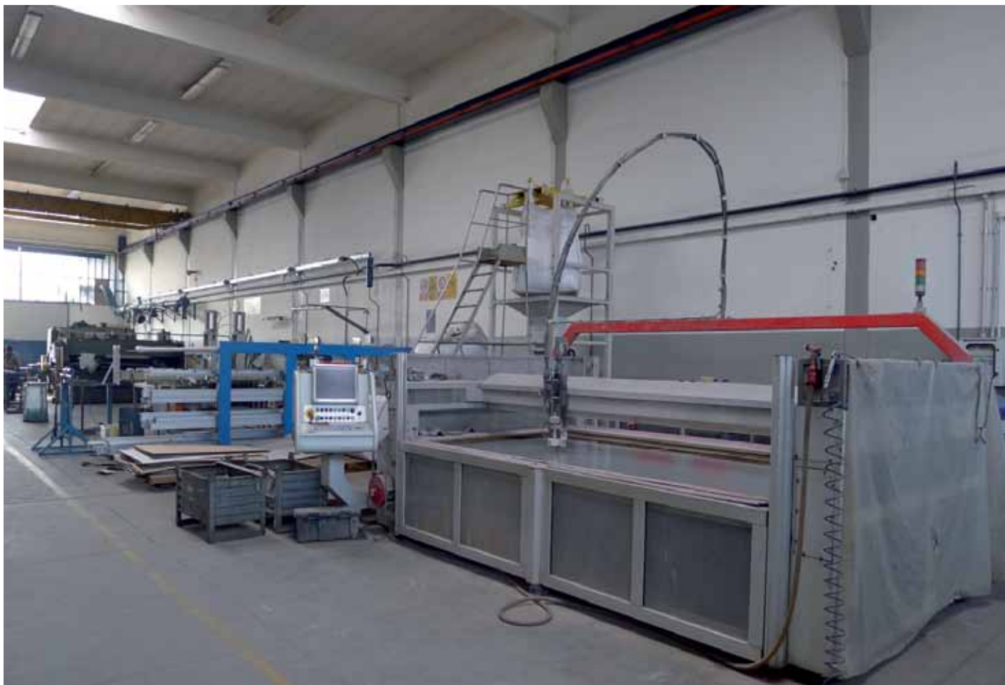
Macchina per il taglio ad acqua delle lamiere.
