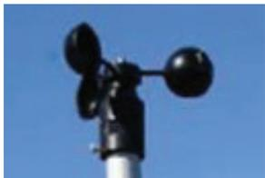
5.1 L'utilizzo dell'anemometro è obbligatorio per le gru a torre automontanti con altezza del gancio superiore a 30 m e per gru a rotazione alta.
