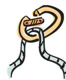
I DPI anticaduta e di trattenuta devono essere utilizzati per i lavori in quota (sopra i 2 m) o con pericolo di caduta dall'alto qualora siano assenti misure di protezione collettiva (es. parapetti, percorsi sicuri, ecc.).
