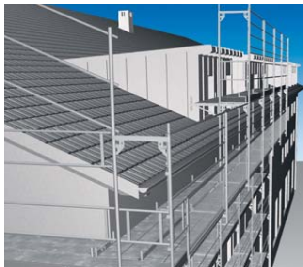
Figura 6 il ponteggio per facciate sporge almeno 80 cm dal bordo del tetto dell'abbaino.
