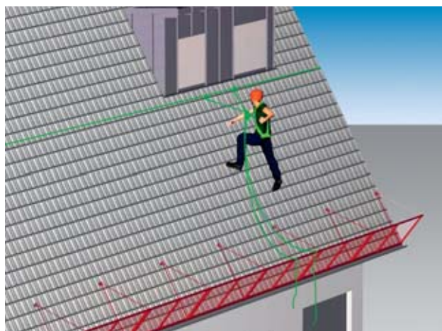
Figura 14 lavoro in sospensione a corde portanti. Come misura supplementare è stata montata una parete di ritenuta sul tetto per arrestare la caduta di materiale.
