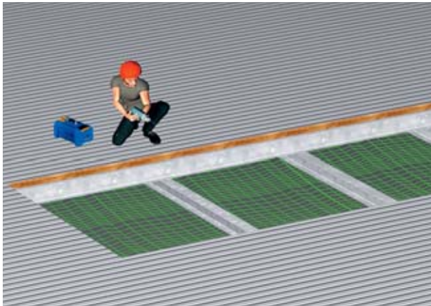
Figura 20 rete di sicurezza montata presso l'apertura per un lucernario
