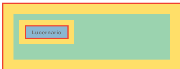
Figura 24 zone di pericolo su un tetto piano
