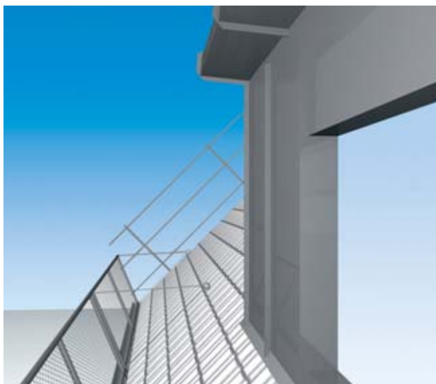
Figura 5 parete di ritenuta sul tetto inadeguata per lavorare su lucernari e abbaini
