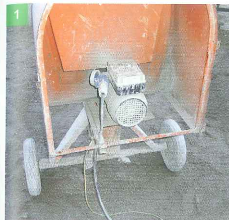
1 CONTROLLA CHE LE MACCHINE SIANO COLLEGATE A TERRA CON L'APPOSITO CAVO GIALLO-VERDE
