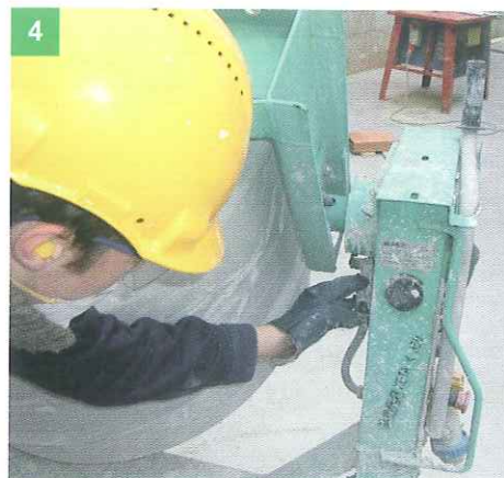
4 CONTROLLA LO STATO DI USURA E DI PULIZIA DELLE PARTI ELETTRICHE VISIBILI DELLA MACCHINA
