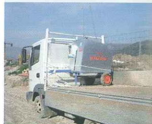
Usa idonei sistemi per bloccare il carico
