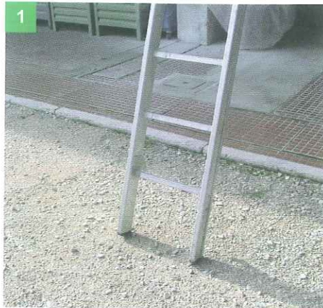
USA SCALE A MANO CON I PIOLI INCASTRATI NEI MONTANTI E CON PIEDINI ANTISDRUCCIOLO
