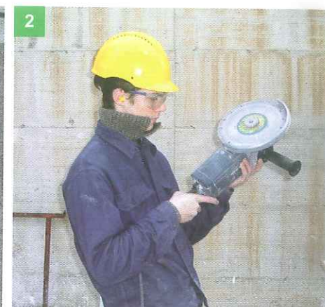
2 CONTROLLA CHE GLI UTENSILI ELETTRICI SIANO A BASSA TENSIONE O DOTATI DI DOPPIO ISOLAMENTO
