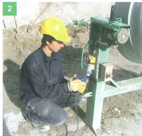
2 CONTROLLA INTEGRITÀ E BUON FUNZIONAMENTO DEI SISTEMI DI SICUREZZA E PROTEZIONI DELLA MACCHINA
