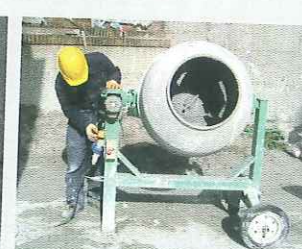
Accertati che l'impianto elettrico della betoniera sia integro
