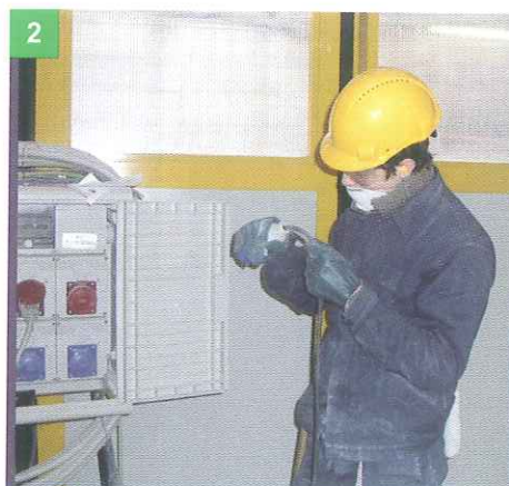
2 CONTROLLA IL BUONO STATO DELLA GUAINA DELLA PROLUNGA E SE PRESA E SPINA SONO BEN FISSATE
