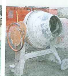
Verifica l'esistenza di protezioni sulla macchina
