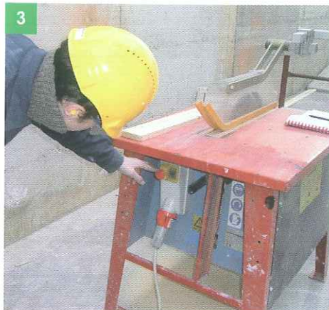
3 CONTROLLA CHE I DISPOSITIVI DI AVVIO E DI FERMO DELLE MACCHINE ELETTRICHE SIANO REGOLAMENTARI
