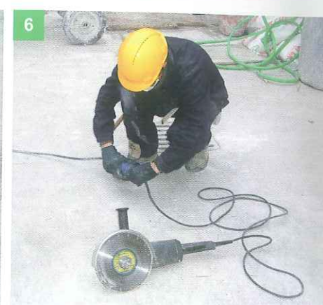
6 NON LASCIARE IN TENSIONE MACCHINE O UTENSILI DOPO L'USO ANCHE PER BREVI PAUSE
