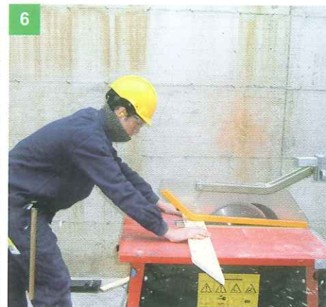
SPINGI IL PEZZO DA TAGLIARE CONTRO IL DISCO CON CONTINUITÀ E TIENI LE MANI LONTANE DAL DISCO
