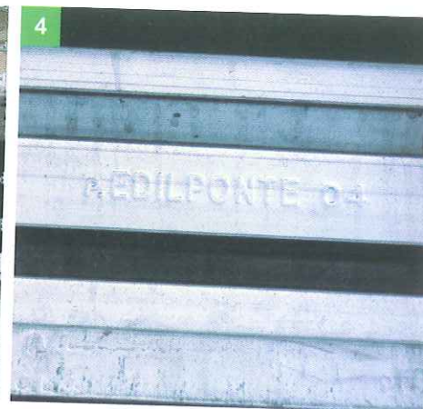
4 MONTA SOLO ELEMENTI DI PONTEGGIO CHE ABBIANO IL MARCHIO DEL FABBRICANTE
