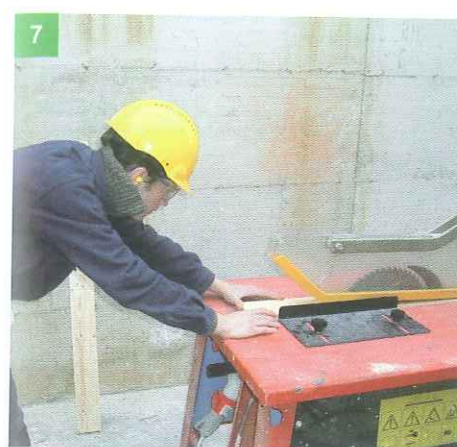
AVVICINANDO AL DISCO PICCOLI PEZZI UTILIZZA LA GUIDA E AIUTATI CON SPINGITOI O STECCHE DI LEGNO
