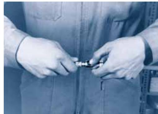
**5** Impianto di aria compressa: usare un raccordo di sicurezza.
