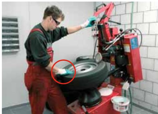
**4** Macchina per il montaggio dei pneumatici: pericolo di schiacciamento.
