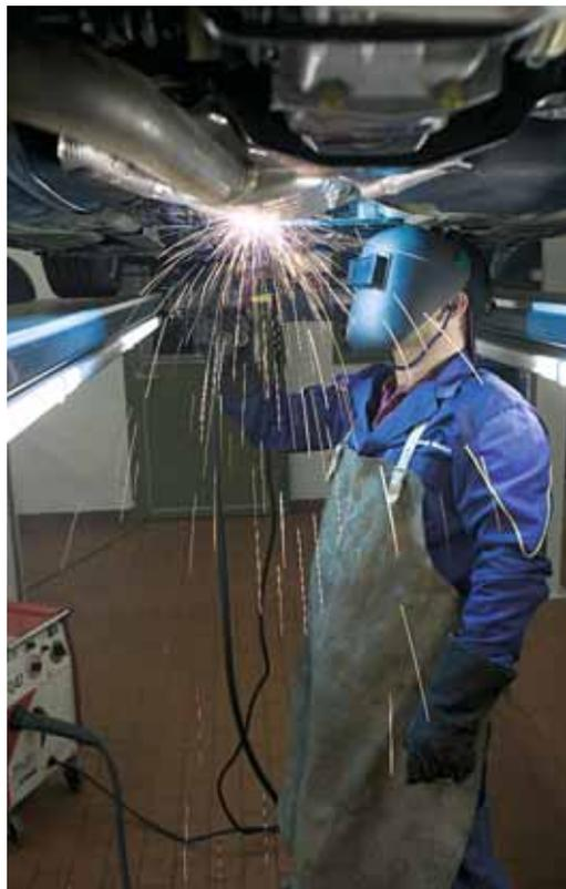
**11 Saldatura con equipaggiamento di protezione.**
