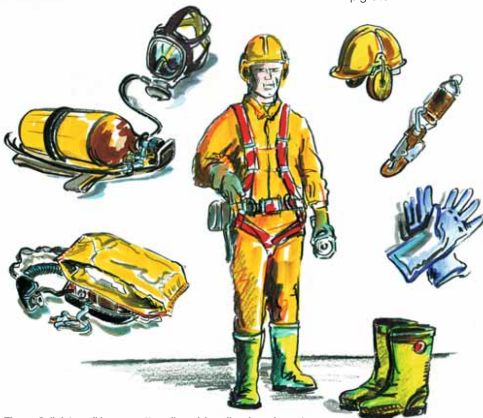
Figura 3: il datore di lavoro mette a disposizione l'equipaggiamento appropriato e deve provvedere affinché esso venga usato correttamente sul lavoro.
