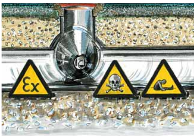
Figura 1: pericoli presenti in pozzi, fosse e canalizzazioni: esplosione, intossicazione e asfissia.
