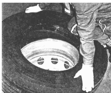
Montaggio del primo tallone
