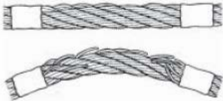
Rotture dei fili nella SEZIONE INTERNA
