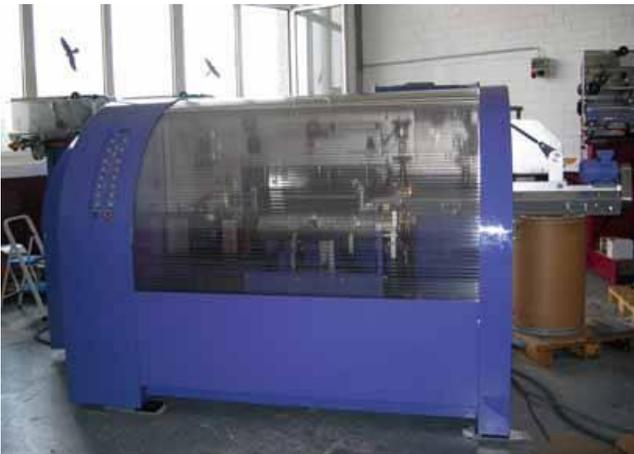
21 Saldatrice automatica incapsulata. Grazie all'incapsulamento il livello sonoro esterno viene ridotto a 82 dB(A).
