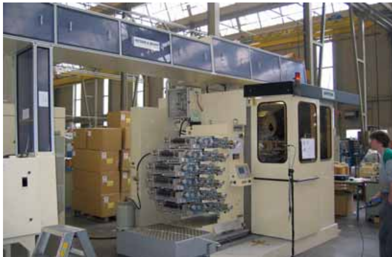
Figura 70: incapsulaggio parziale su una macchina per la stampa di tubi (200 tubi al min.); a un metro di distanza il livello sonoro è di 77 dB(A).
