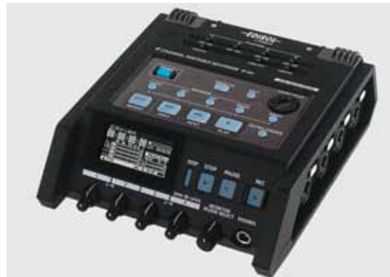
Figura 55: registratore digitale a 4 canali.
