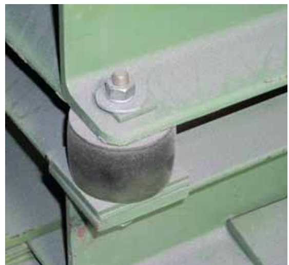
Figura 68: elemento in gomma per il basamento di un ventilatore.
