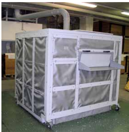
Figura 71: incapsulaggio di un trituratore per rifiuti plastici. Riduzione del rumore: circa 12 dB(A).
