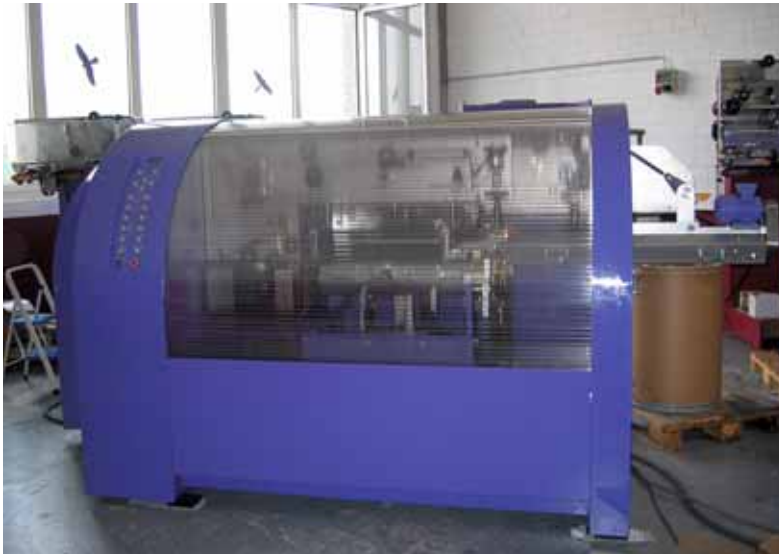
Figura 72: incapsulaggio di un impianto per la saldatura delle lattine. Grazie alla capsula il livello sonoro sulla parete esterna si è ridotto a 82 dB(A).
