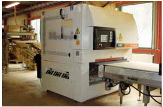
Figura 74: impianto di imballaggio completamente incapsulato. La capsula riduce le emissioni sonore di 17 dB(A).
