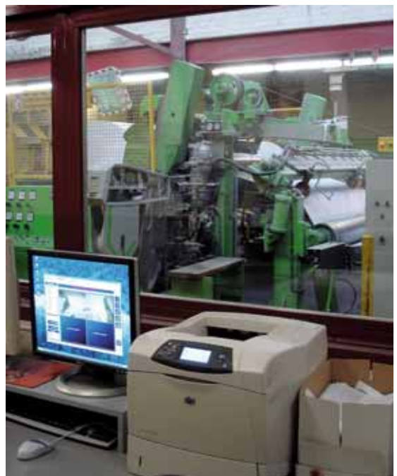
Figura 75: sala di comando di una macchina per carta. All'interno della sala di comando il rumore di fondo è di 65 dB(A), mentre all'esterno il rumore può raggiungere i 90 dB(A).
