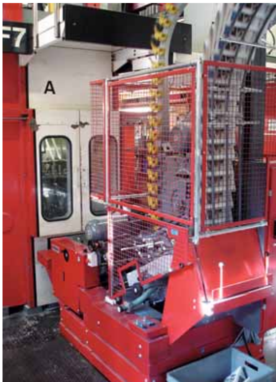
Figura 73: macchina per la stampa rotativa con piegatrice incapsulata. Il livello sonoro passa da 98 a 84 dB(A).
