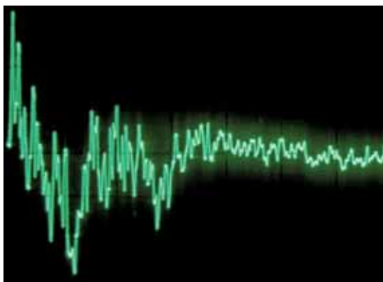
Figura 25: scoppio dell'airbag, livello di picco L_{peak} = 160 \text{ dB(C)} .
