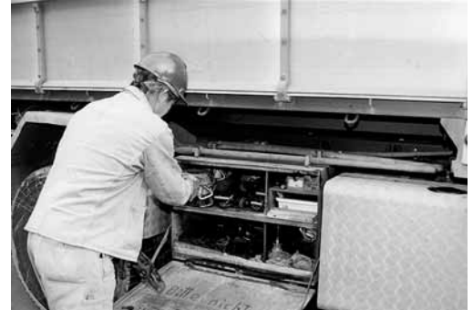
Fig. 1: i mezzi d'imbracatura vengono trasportati in appositi contenitori in modo da averli sempre a portata di mano.
