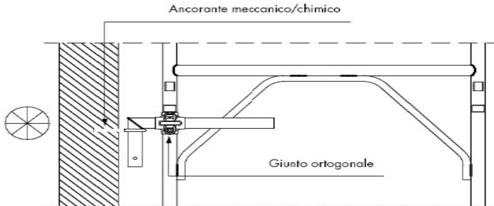
Fig. 5.5-3 Esempio di ancoraggio con elemento a squadro e ancorante meccanico o chimico
