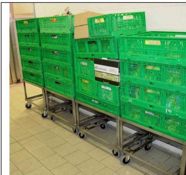
Fig. 22 – merce collocata su carrelli idonei e con punto di presa inferiore all’altezza delle spalle
