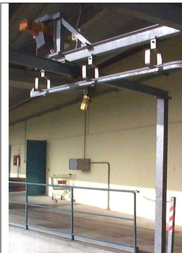
Fig. 11 – apparecchio di sollevamento (esterno) di quarti e mezzene per passaggio da camion a guidovia e cella frigo
