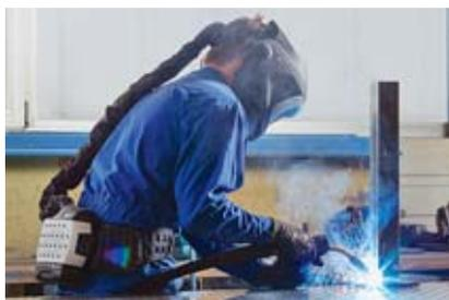
1 Casco da saldatore con elettroventilatore con filtro integrato
