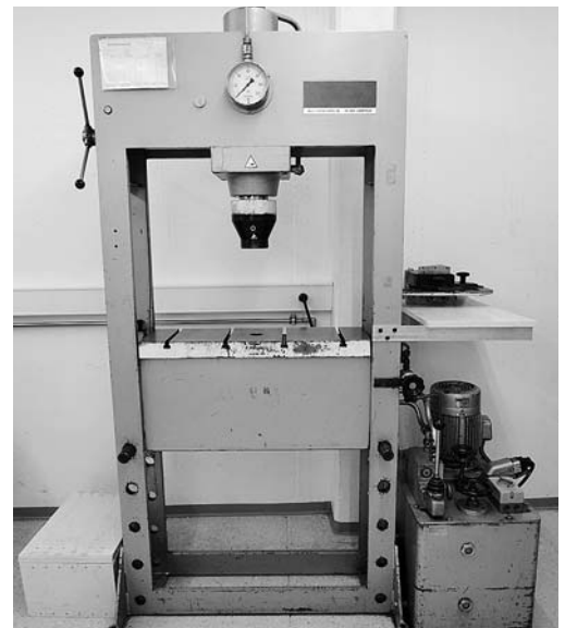
Fig. 3: pressa idraulica da officina.
