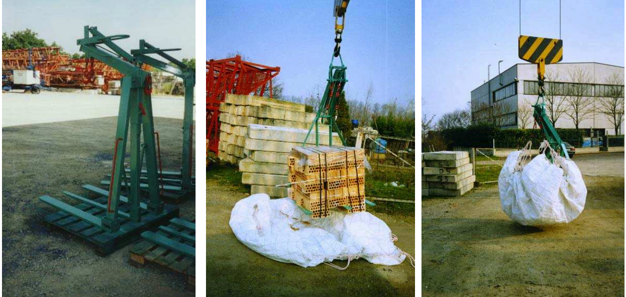
fig. 19 - sacco per imbrago e sollevamento laterizi tramite forca – rete a maglie 50 x 50 con telo in polipropilene e 8 anelli perimetrali a chiusura del sacco – foto e produzione Tecnobrevetti
