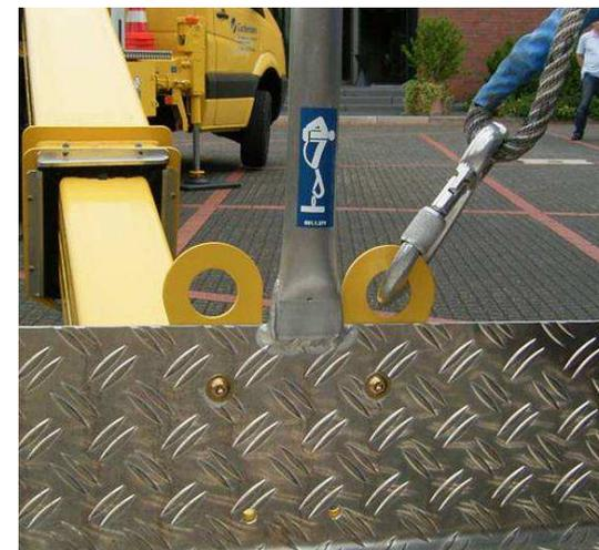
4 Usare sempre i punti d'ancoraggio indicati dal costruttore della PLE (>3KN). Posizione del punto d'ancoraggio: possibilmente più vicino al piano di calpestio, max. altezza corrente. Non ancorarsi mai alla ringhiera!
