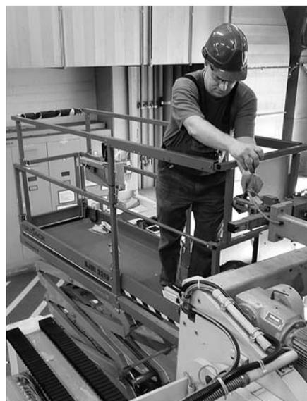
Fig. 5: per i lavori di lubrificazione in altezza si usa una piattaforma di lavoro elevabile.
