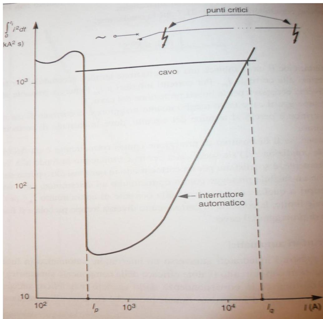
**L'interruttore automatico protegge il cavo per valori di corrente compresi nell'intervallo corrispondente ai punti di intersezione tra le due curve.**
