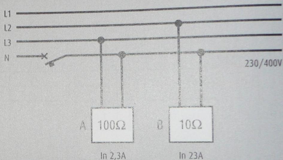
Gli utilizzatori A e B risultano collegati in serie tra L2 L3 alla tensione di 400V con un assorbimento di 3,45A; l'utilizzatore A è sovraccaricato
