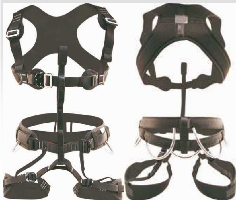
figura 1 Esempio di Imbracatura per il corpo con attacco sulla schiena per l'arresto caduta e attacco per il posizionamento sul lavoro Legenda 1 Bretella 2 Cinghia secondaria 3 Cinghia di seduta (cinghia primaria) 4 Cosciale 5 Supporto schiena per posizionamento sul lavoro 6 Elemento di regolazione 7 Elemento di attacco per arresto caduta 8 Fibbia 9 Elemento di attacco per posizionamento sul lavoro a Marcatura, vedere 6 b Marcatura con lettera maiuscola "A"
