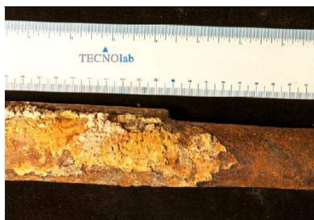
Fig. 7. Depositi presenti sulla superficie esterna del Tubo n° 27
