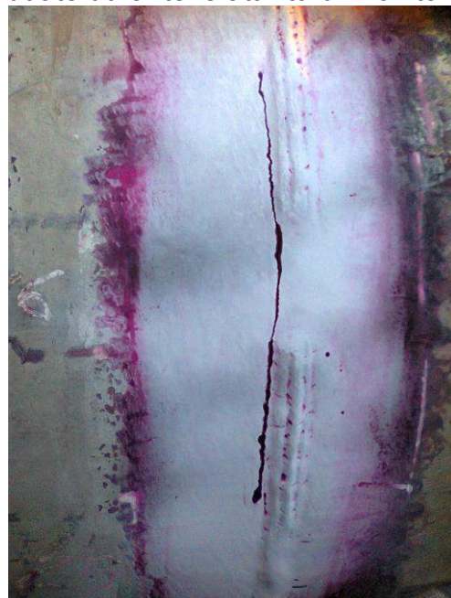
Individuazione dell'estensione della cricca tramite LP
