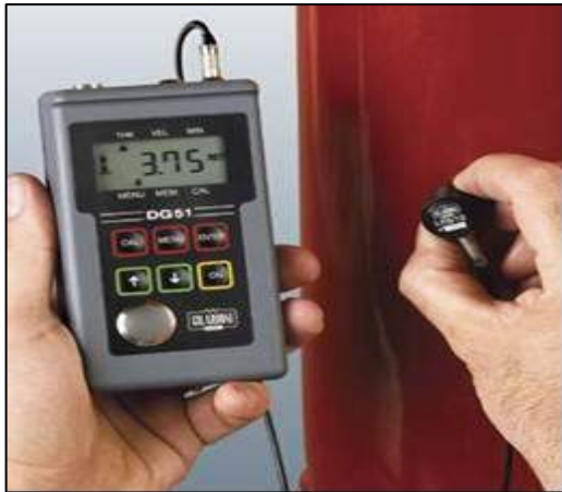
Fig. 5 - Spessimetro Gilardoni mod. DG 51
