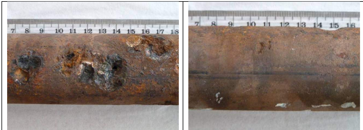
Figura 1- Alcune fotografie scattate in occasione dell'esame visivo di un tubo in acciaio basso legato affetto da corrosione localizzata (pitting).
