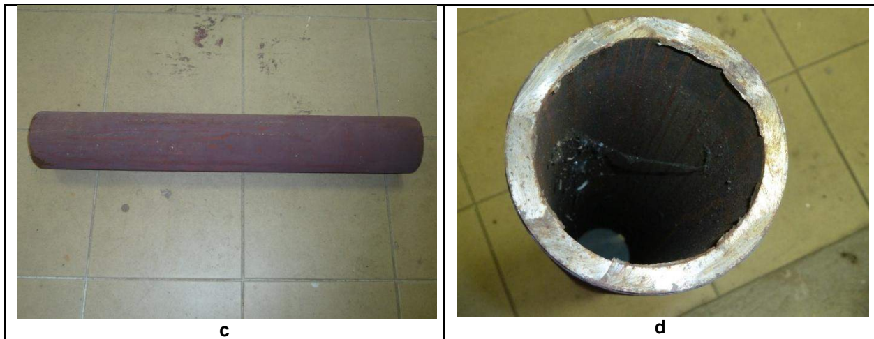
Figura 2 - (a) (b) il collettore SH2 in ASTM A335 gr. P22: visione del pezzo e macro della saldatura esaminata; (c) (d) il tubo in ASTM A 213 gr. P91
