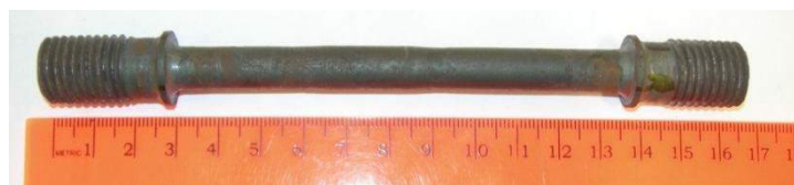
Figura 2: Provino estratto dal tallone. Lunghezza totale: 163 mm; lunghezza utile di misura: 98 mm; diametro della parte utile di misura: 10 mm
