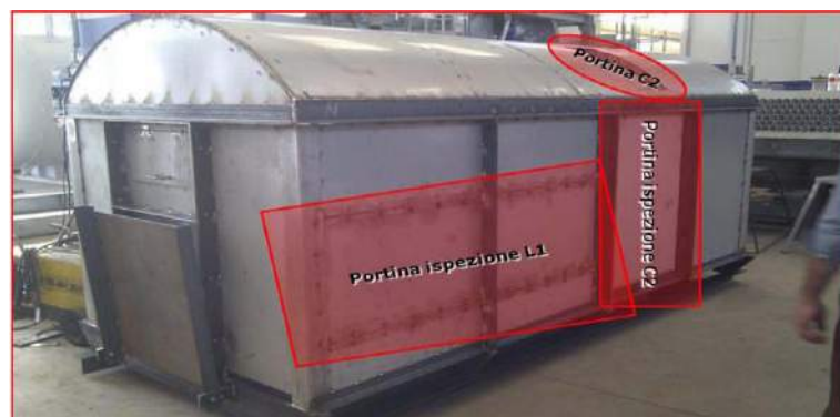
Figura 12 – Box interno al degasatore di alloggiamento degli ugelli e delle vaschette
