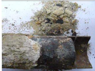
Fig. 15. Aspetto del deposito e relativo punto di prelievo
