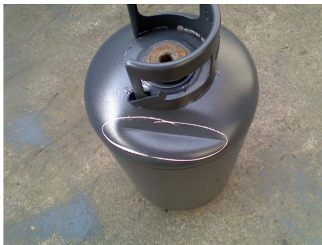
Foto 1: Ammaccatura di rilevante entità a spigolo vivo.
