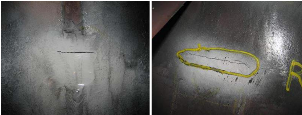
Figura 5 – Individuazione mediante controlli MT delle cricche sulla superficie interna
