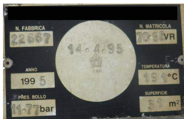
Fig. 3 – Targhetta identificativa dell'attrezzatura
