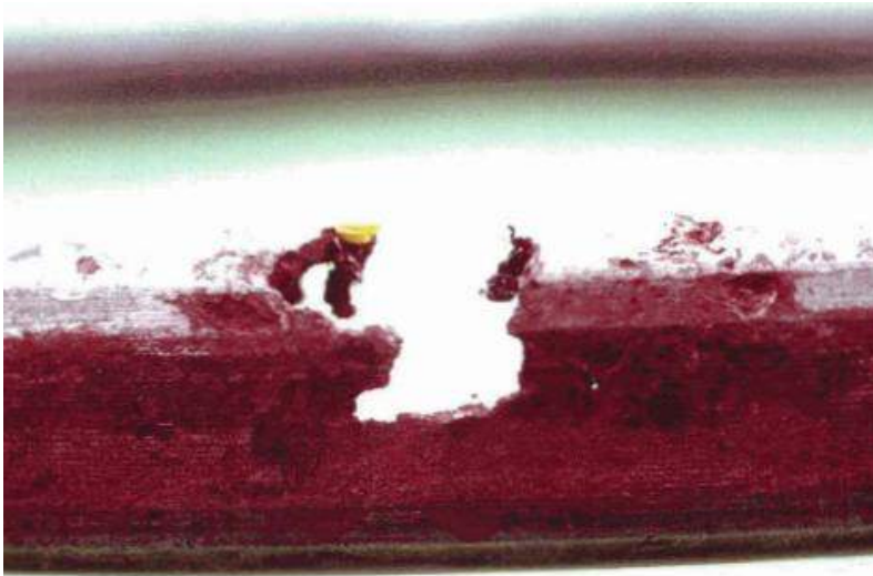
Fig.8: Foratura per interferenza elettrica
