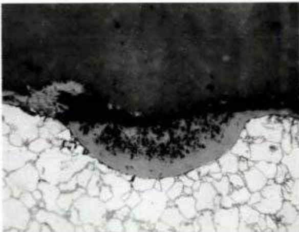
Fig.1: Esempio di corrosione localizzata nella parte bassa dei tubi
