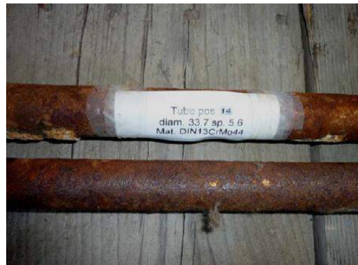
Fig. 4. Fotografia del Tubo n° 14 in acciaio DIN 13CrMo44, allo stato “come pervenuto”
