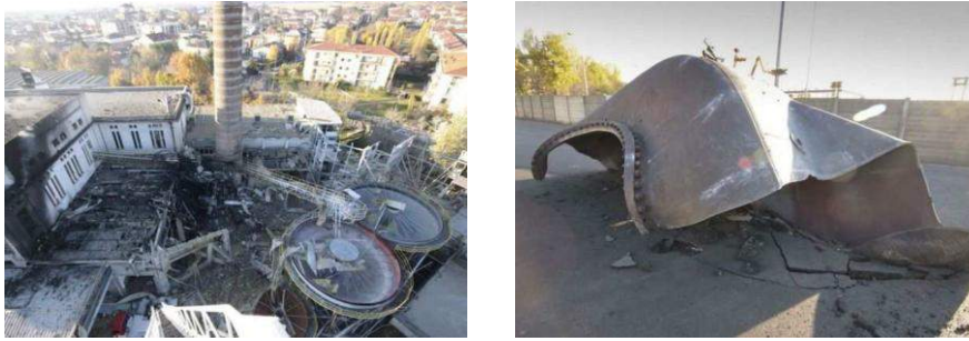
Foto 1-2: Generatore di vapore esploso (BG - Italia) nov. 2011
