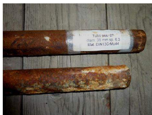
Fig. 6. Fotografia del Tubo n° 27 in acciaio DIN 13CrMo44, allo stato “come pervenuto”
