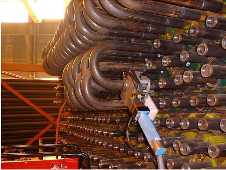
Fig. 1 – Vista della fase di esecuzione di saldature dei raccordi di un fascio tubiero
