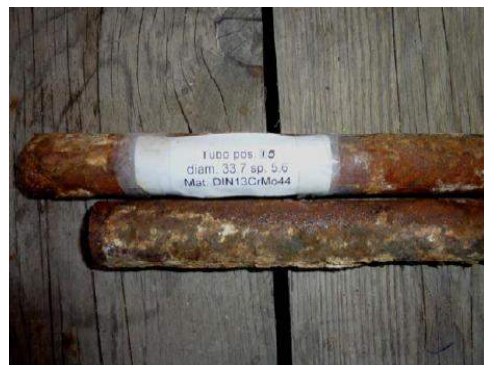
Fig. 5. Fotografia del Tubo n° 15 in acciaio DIN 13CrMo44, allo stato “come pervenuto”
