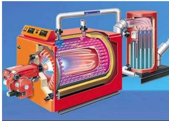
Fig. 2 - Generatore di vapore con recupero del calore contenuto nei fumi
