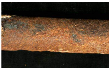
Fig. 8. Tubo n° 27 :Aspetto di una zona corrosa
