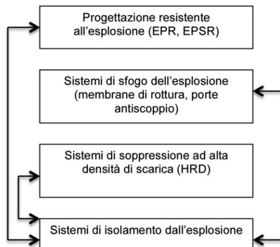
Figura 3 – Correlazione tra protezione e isolamento dall'esplosione
