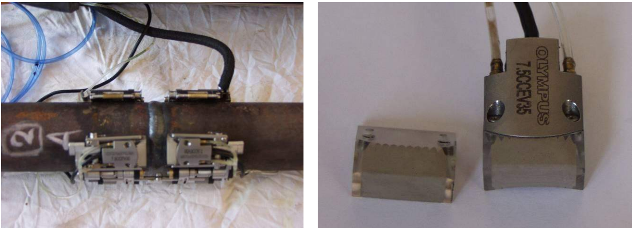
Fig. 3 – Vista dello scanner automatizzato COBRA della Olympus e di dettaglio delle sonde PA impiegate nel corso dell'attività di qualificazione della metodica
