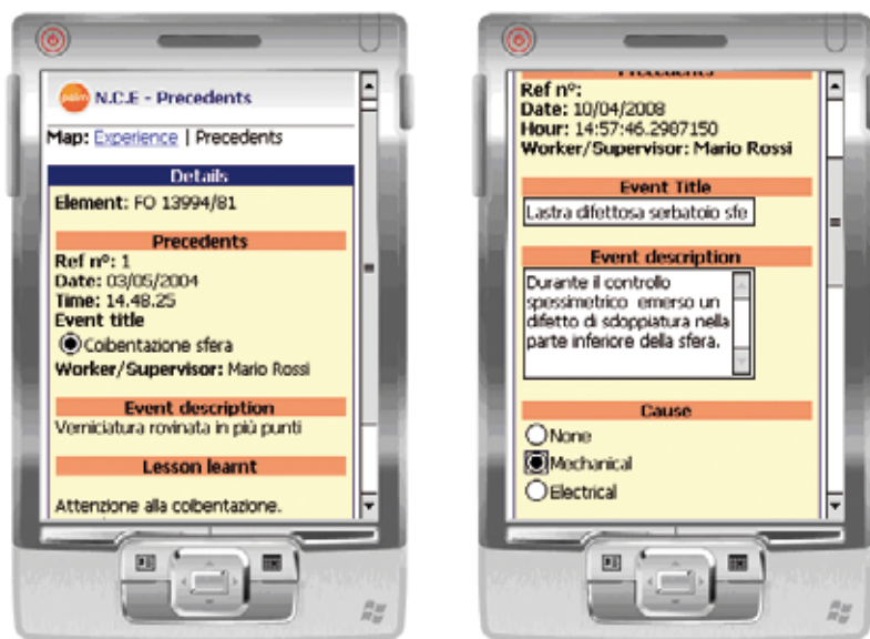
Figura 6.4.2 Esempio di utilizzo di NoCE nella versione palmare. A sinistra un esempio di consultazione dei precedenti accaduti al componente in esame, a destra la registrazione di una segnalazione di anomalia riscontrata
