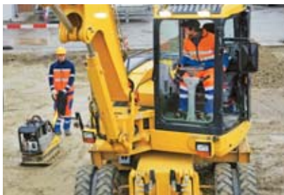
2 Lavoratore nella zona di pericolo di una macchina edile
