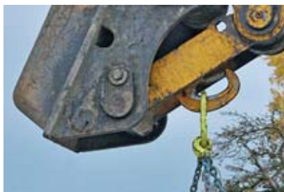
1 Dispositivo di aggancio con sicura: accessori di sollevamento adeguati
