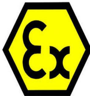
Figura 4: Marchio di protezione dalle esplosioni
