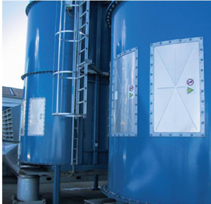
Figura 7: Pannelli di rottura
