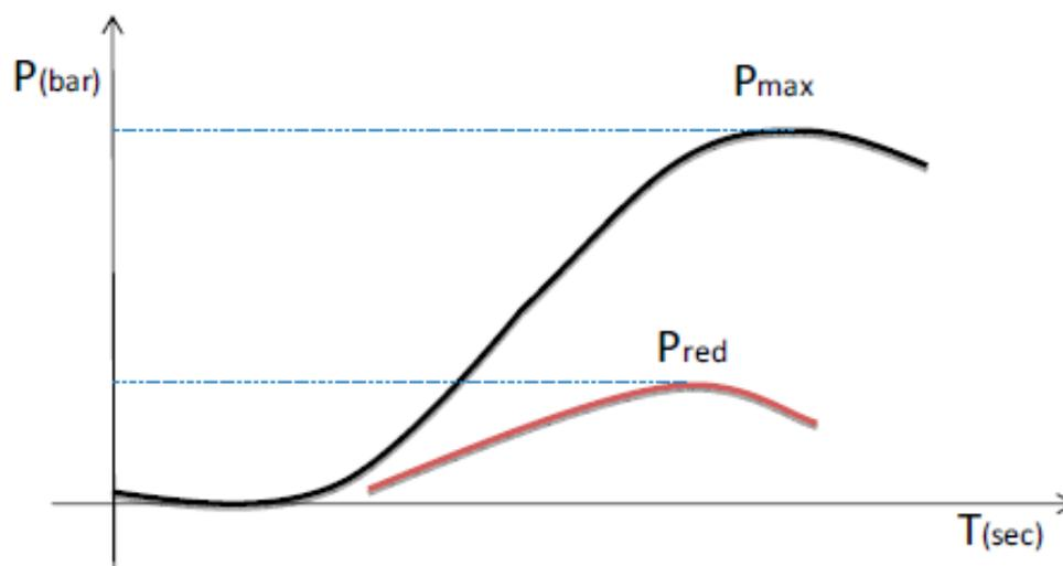
Figura 5: Andamento della pressione all'interno del volume di esplosione
